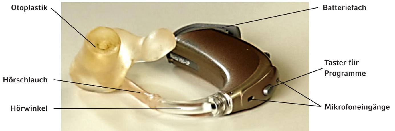
Abb. 1: Hinter-dem-Ohr Hörgerät
